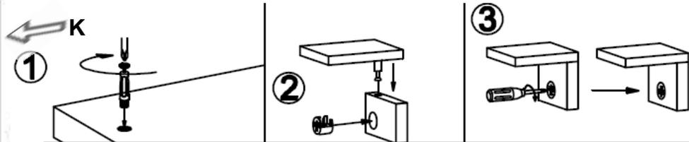
Verwenden Sie zum Festziehen der Nockenschrauben einen Schraubenzieher und keinen Akkuschauber
