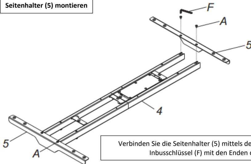
Verbinden Sie die Seitenhalter (5) mittels der Schrauben (A) und dem Inbusschlüssel (F) mit den Enden des Trägers (4).
