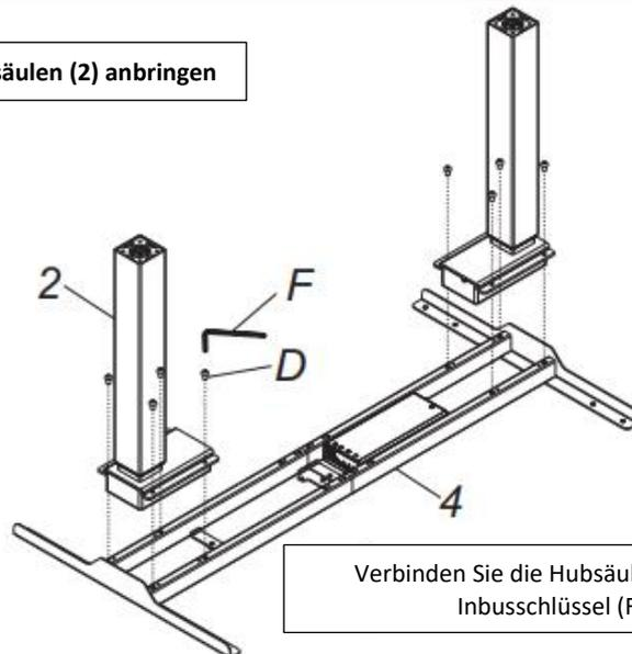
Verbinden Sie die Hubsäulen (2) mittels der Schrauben (D) und dem Inbusschlüssel (F) mit den Enden des Trägers (4).
