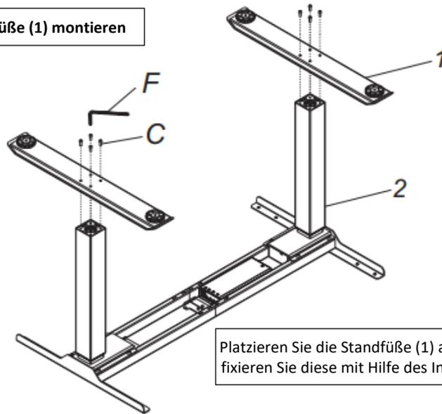
Platzieren Sie die Standfüße (1) auf der Unterseite der Hubsäulen (2) und fixieren Sie diese mit Hilfe des Inbusschlüssels (F) mit den Schrauben (C).
