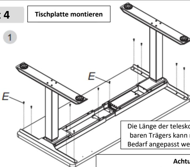
Die Länge der teleskopierbaren Trägers kann nach Bedarf angepasst werden.
