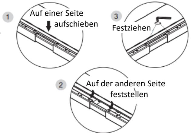
Setzen Sie die Schrauben (B) zunächst nur lose am Träger (4) an. Fixieren Sie erst eine, dann die andere Seite der Kabelführung (3) mit den Schrauben. Zum Schluss ziehen Sie die Schrauben (B) mit dem Inbusschlüssel (F) fest.
