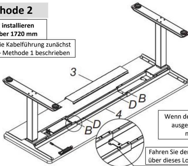
Wenn der Träger auf mehr als 1720 mm Breite ausgefahren wird, muss die Kabelführung mittig am Träger fixiert werden.
