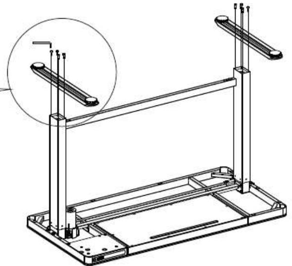
Installieren Sie die Standfüße (3) mit den M6-Schrauben (A) auf den Hubsäulen (2) und ziehen sie mit Inbusschlüssel (C) fest.
