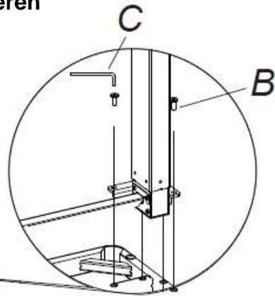
Montieren Sie die Hubsäulen (2) mit den Schrauben (B) auf der Tischplatte (1) und ziehen sie mit dem Inbusschlüssel (C) fest.
