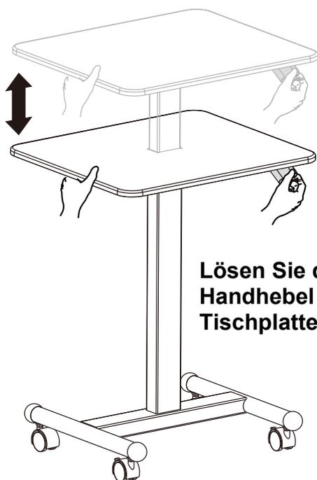
Lösen Sie die Fixierung mit dem Handhebel und bewegen Sie die Tischplatte in die gewünschte Position
