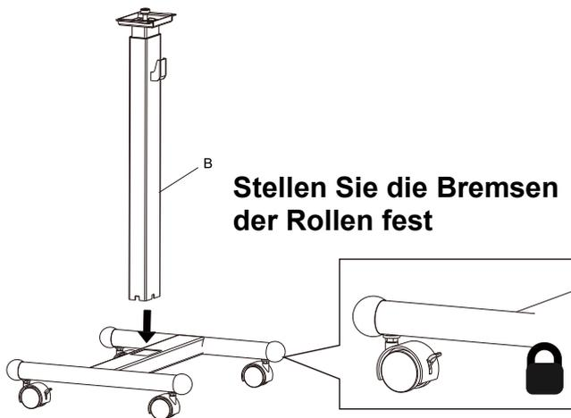
Verschrauben Sie den Rollwagen von unten mit der Hubsäule
