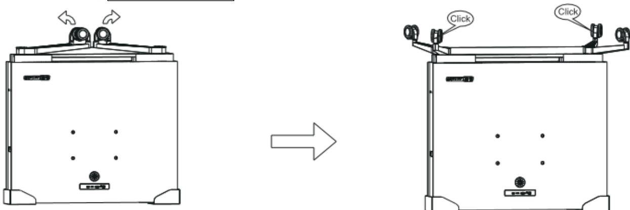
Klappen Sie die FüÙe in Pfeilrichtung (wie auf der Zeichnung dargestellt) nach außen. Wenn Sie ein Klicken hören, sind die FüÙe korrekt
