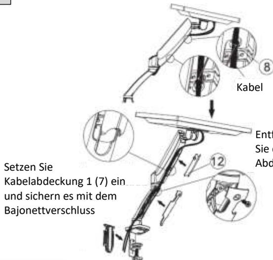
Setzen Sie Kabelabdeckung 1 (7) ein und sichern es mit dem Bajonettverschluss
