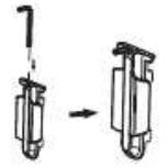
Wenn der Bildschirm nach der Montage nicht auf eine beliebige Höhe eingestellt werden kann, verwenden Sie den Inbusschlüssel (F) wie in der Zeichnung dargestellt, um den Monitor und den Haltearm auszubalancieren, sodass sich die Höhe wie gewünscht regulieren lässt. Um den Monitor höher zu stellen drehen Sie Richtung - und um ihn tiefer zu stellen in Richtung +
