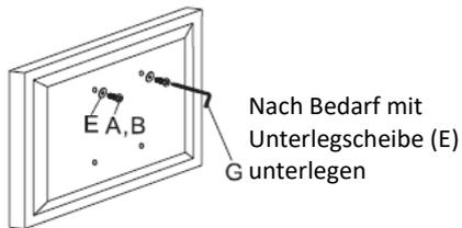
Nach Bedarf mit Unterlegscheibe (E) unterlegen
