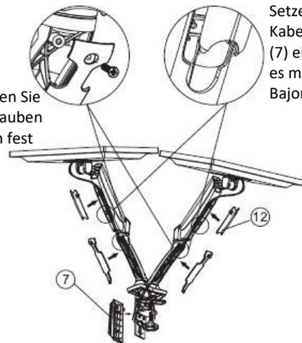
Setzen Sie die Kabelabdeckung 1 (7) ein und sichern es mit dem Bajonettverschluss
