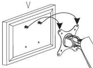
Wenn der Bildschirm nach der Montage nicht auf eine beliebige Höhe eingestellt werden kann, verwenden Sie den Inbusschlüssel (G) wie in der Zeichnung dargestellt, um den Monitor und den Haltearm auszubalancieren, sodass sich die Höhe wie gewünscht regulieren lässt. Um den Monitor höher zu stellen drehen Sie Richtung – und um ihn tiefer zu stellen in Richtung +
