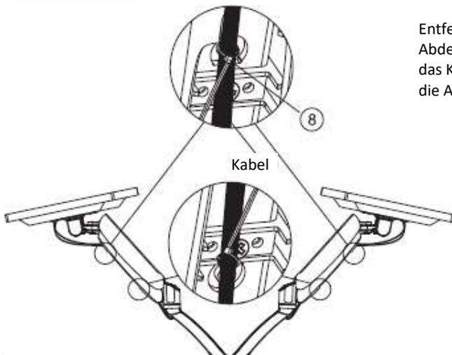
Entfernen Sie die Abdeckungen (12), legen Sie das Kabel ein und schrauben die Abdeckungen dann fest
