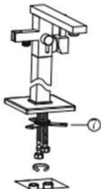
7. Verschrauben Sie den Bolzenhalter mit dem Wasserhahn
