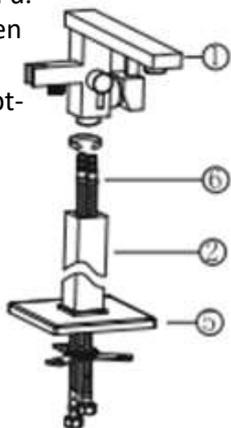
2. Verschrauben Sie das Hauptteil mit dem geraden Rohr
