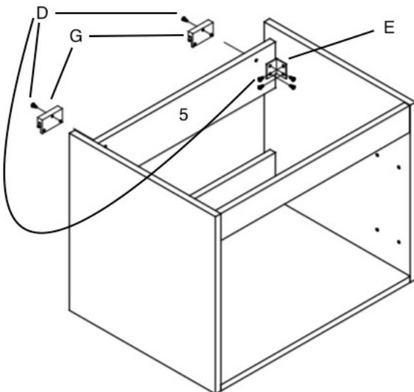
2. Befestigen Sie nun die beiden Teile G an Teil 5 mithilfe der Schrauben D. Verstärken Sie anschließend auf beiden Seiten die Befestigung des Teiles 5 an den Seitenstücken mithilfe der beigelegten Winkelteile.
