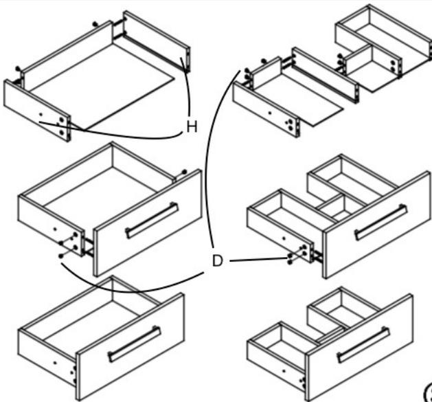
3. Montieren Sie nun die einzelnen Schubladenteile mithilfe der Schrauben D wie auf der Abbildung gezeigt. Anschließend befestigen Sie die Ausziehschienen an den Schubladenwänden, danach die Auszugsschienen ausziehen und an der inneren Seitenwand befestigen.
