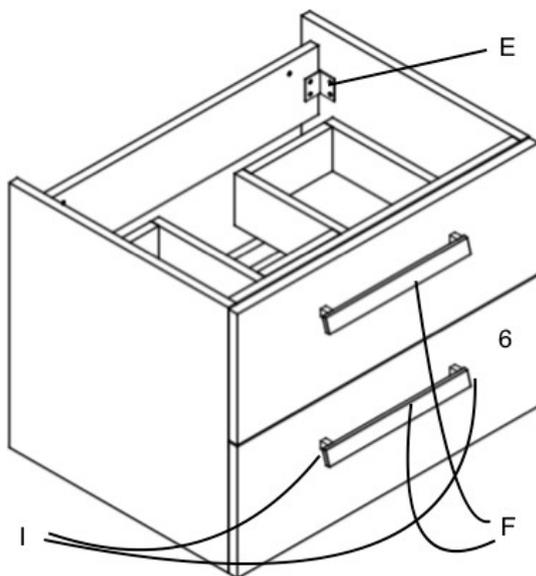
4. Montieren Sie den Schubladengriff F an die Außenseite der Schublade (6) mithilfe der beiden Schrauben I
