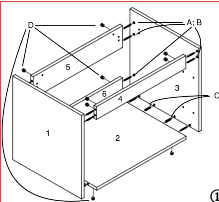
1. Nehmen Sie das Seitenteil 1 und verschrauben Sie es mithilfe der Teile A und B (Teile A und B werden immer in Kombination genutzt) mit den Mittelstücken 5, 6 und 4. Anschließend befestigen Sie die Unterseite 2 mit 1. Ziehen Sie die Schrauben noch nicht fest, befestigen Sie vorher Seitenteil 3 mit den Mittelstücken sowie Unterseite.
