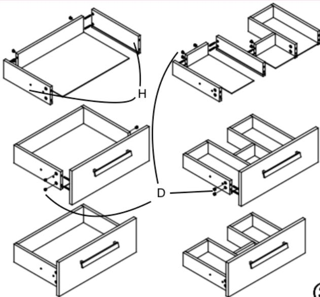
3. Montieren Sie nun die einzelnen Schubladenteile mithilfe der Schrauben D wie auf der Abbildung gezeigt. Anschließend befestigen Sie die Ausziehschienen an den Schubladenwänden, danach die Auszugsschienen ausziehen und an der inneren Seitenwand befestigen.
