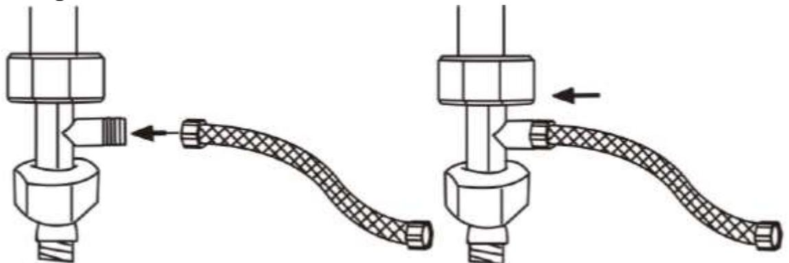
Verbinden Sie den Zulaufschlauch und den Edelstahl-Gewebeschlauch mit dem dem 3-Wege Ventil
