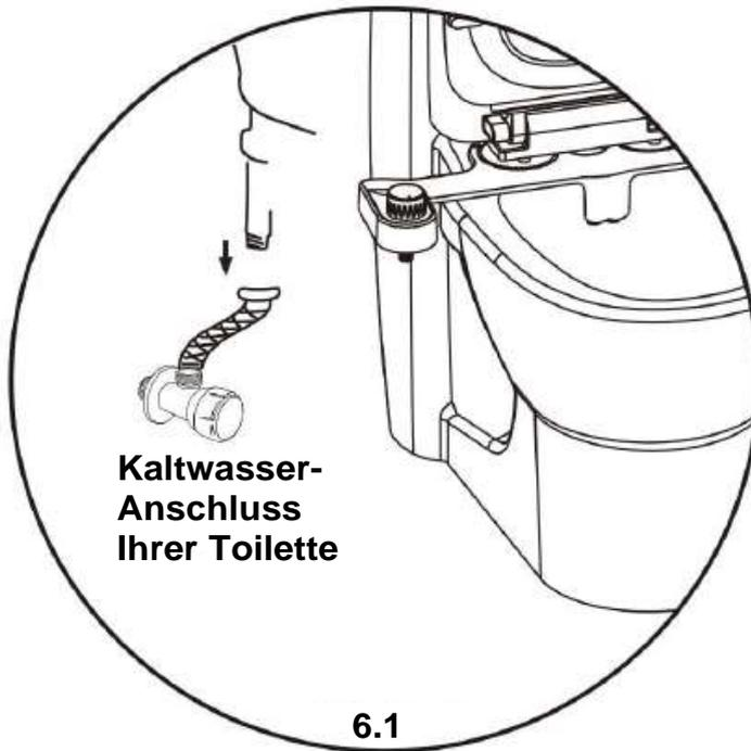
Stellen Sie sicher, dass der Wasserzulauf geschlossen und der Wassertank vollständig entleert ist
