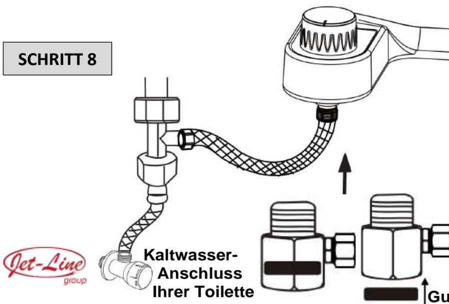
Verbinden Sie den Edelstahl-Gewebeschlauch mit dem Bidet-Anschluss. Achten Sie dabei darauf, das Gewinde nicht zu überdrehen. Schrauben Sie hierfür die Verbindung erst von Hand fest und ziehen Sie dann mit dem Schraubenschlüssel um maximal eine viertel bis halbe Umdrehung an
