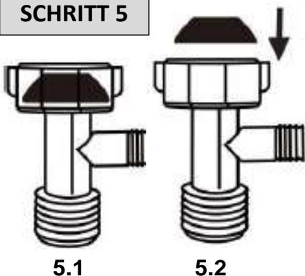
Setzen Sie die schwarze Gummidichtung oben auf das 3-Wege Ventil auf
