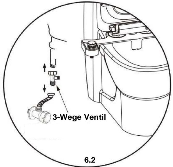
Verbinden Sie das 3-Wege Ventil gemäß Abbildung mit dem Wasseranschluss
