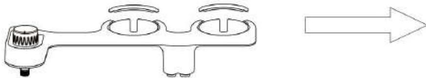
Setzen Sie den Bidet-Aufsatz so ein, dass die Düse mittig sitzt und lassen die Stifte des Toilettensitzes einrasten.
