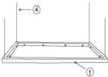
1. Legen Sie den Tischrahmen ohne Glasplatte auf eine weiche Unterlage und befestigen Sie die Gewindestangen. (Um die Stabilität noch zu erhöhen, können Sie die Gewindestangen zusätzlich mit einer Kontermutter am Tischrahmen fixieren)
