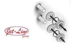
Nehmen Sie die Muttern, Federscheiben und Unterlegscheiben von allen vier Sprengbolzen ab und legen diese für den nächsten Schritt beiseite
