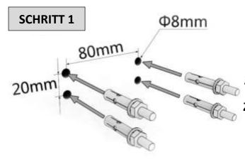
Zeichnen Sie die Bohrlöcher für die Wandhalterung gemäß der Zeichnung an und platzieren Sie die vier Sprengbolzen
