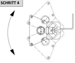
Nun können sie noch den gewünschten Neigungswinkel einstellen. Lösen Sie hierfür die beiden M6x10 Schrauben, positionieren Sie den Heizer wie gewünscht und ziehen Sie die Schrauben dann wieder fest
