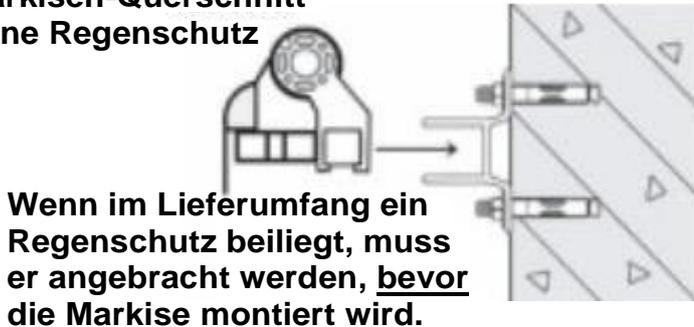
Wenn im Lieferumfang ein Regenschutz beiliegt, muss er angebracht werden, bevor die Markise montiert wird.
