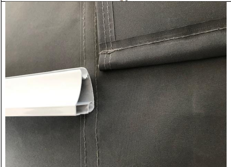
Tuch in die vordere Schiene einfügen
