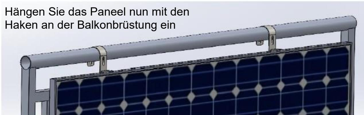
Oben wird der Haken (E), wie auf den Bildern zu sehen, mit einer M12x100 Bolzen-Kombination gesichert
