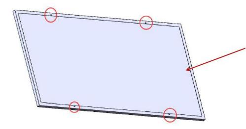
Die oberen und unteren Halter werden mit den Befestigungslöchern auf der Rückseite des Solarpaneels verschraubt
