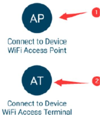
1. Der Wechselrichter muss im AP-Modus laufen. Das Mobiltelefon muss mit dem Hotspot des Wechselrichters verbunden sein (s. Schritt 3.1.)
