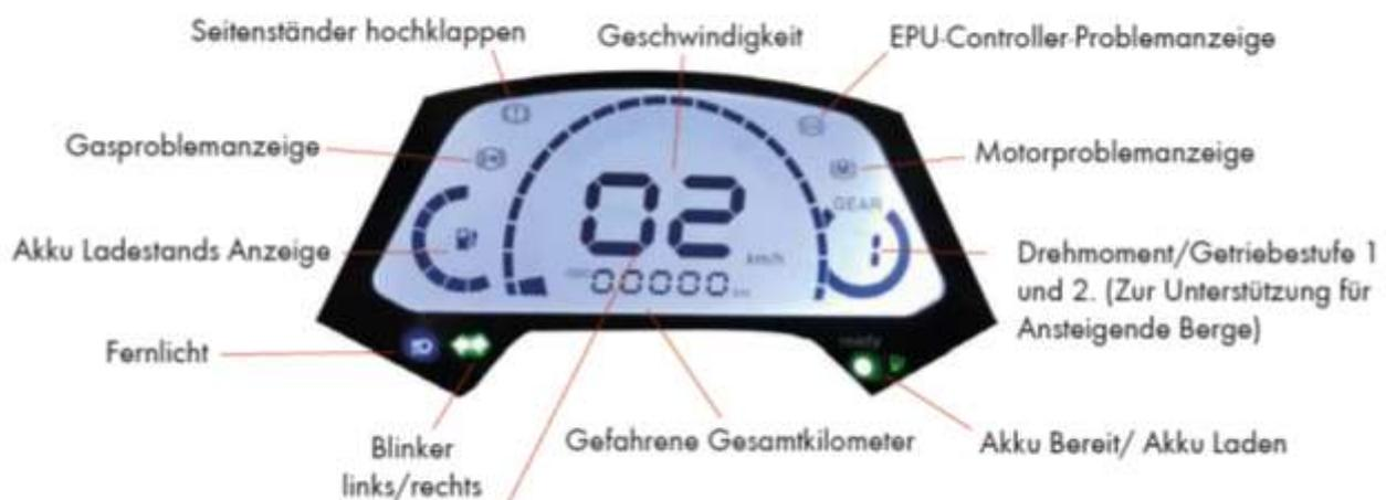
Sollte ein „P“ auf dem Display erscheinen, ist das die Parkposition (Wegfahrsperr), diese können sie mit anziehen der linken Bremse lösen.
