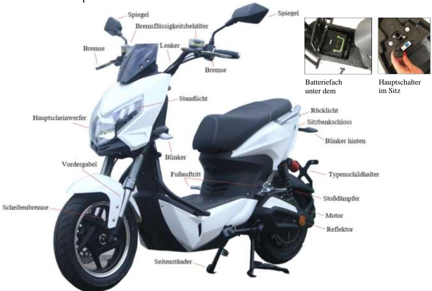
Sie erhalten Ihren JET-LINE POWER SCOOTER zu 95% montiert – lediglich die Spiegel müssen noch angebracht werden (einfaches Drehgewinde mit Kontermuttern gesichert).
