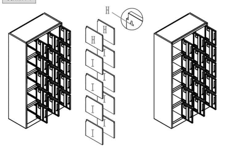
4. Montieren Sie die Zwischenwände wie auf der Zeichnung dargestellt
