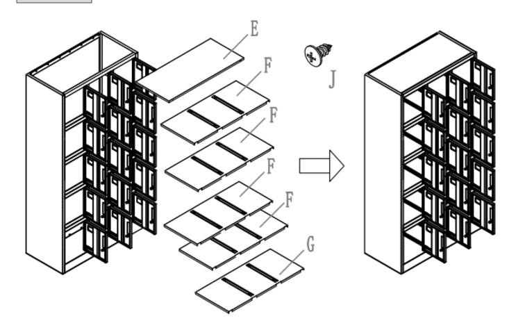
3. Installieren Sie die obere Abdeckung, die Zwischenböden F und die Bodenplatte G
