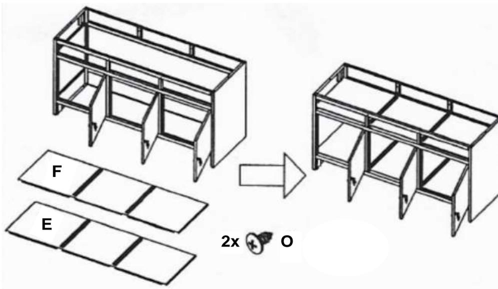
**SCHRITT 5** Montage der unteren Zwischenwände (G)
