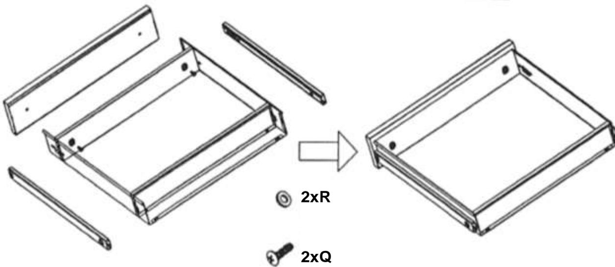
**SCHRITT 11** Einsetzen der Schubladen (L)
