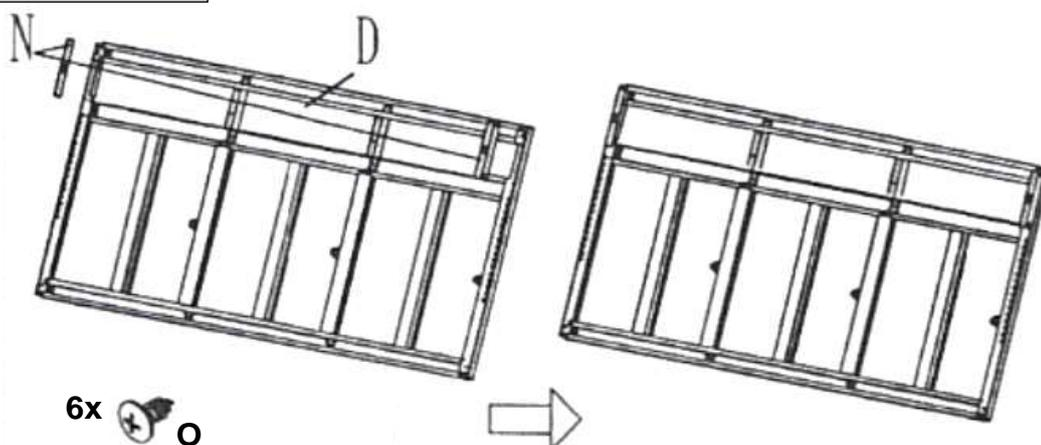
**SCHRITT 3** Montage des vorderen Rahmens (D)
