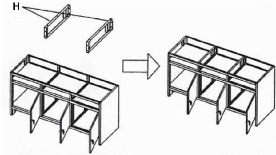
**SCHRITT 7** Montage der oberen Abdeckung (M)
