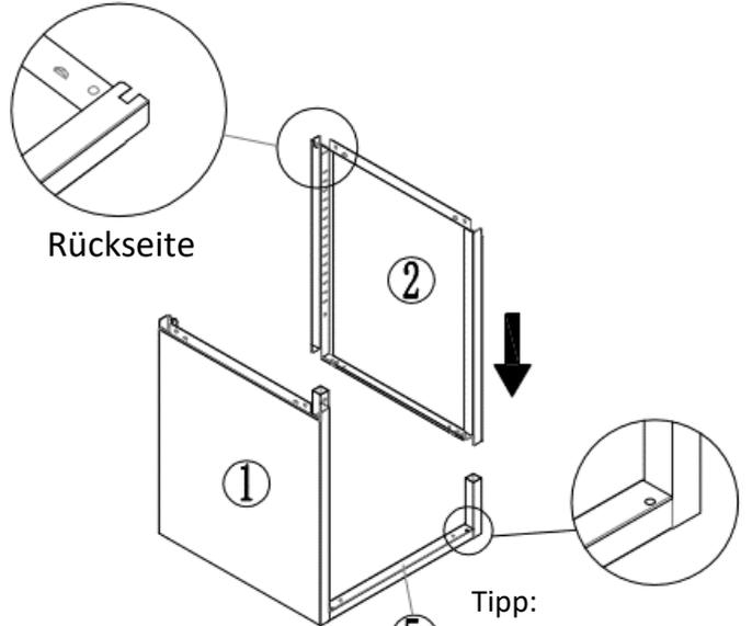
Tipp: Diese Bohrung ist nach außen gerichtet
