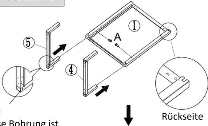
Tipp: Diese Bohrung ist nach innen gerichtet
