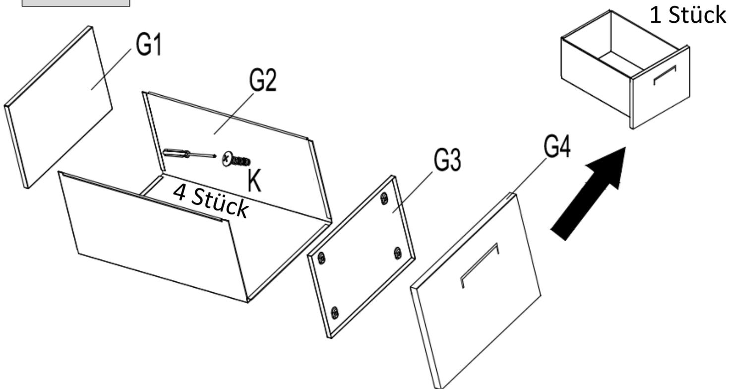
6. Montieren Sie die Teile G (1-4) wie abgebildet und verschrauben Sie die Schienen E an den Schubladenseiten
