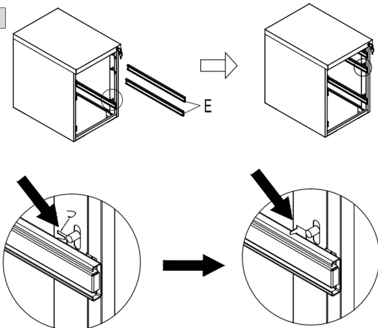
4. Montieren Sie die Schubladenschiene E wie abgebildet an den Innenseiten der Seitenwände C1 und C2
