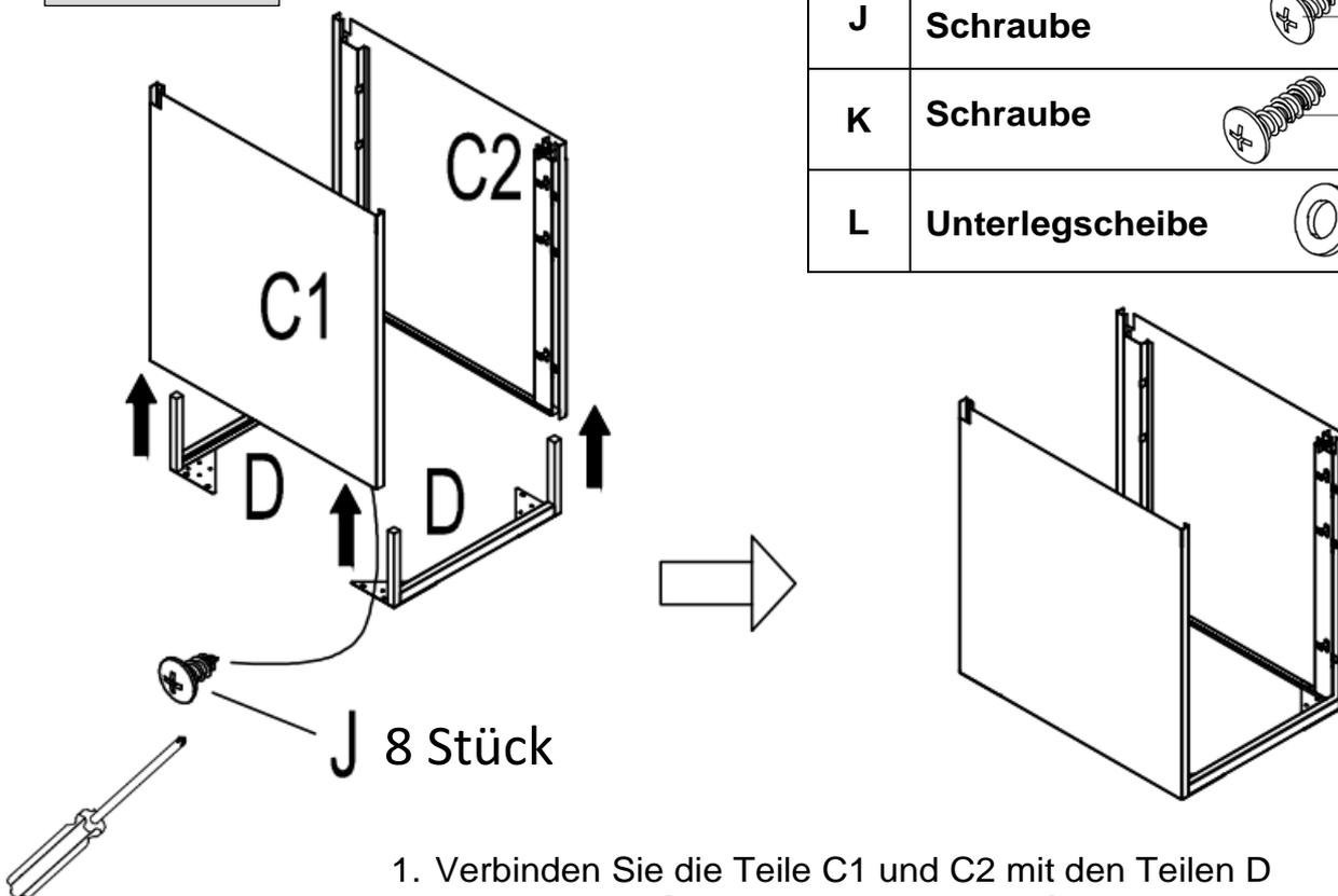
1. Verbinden Sie die Teile C1 und C2 mit den Teilen D
