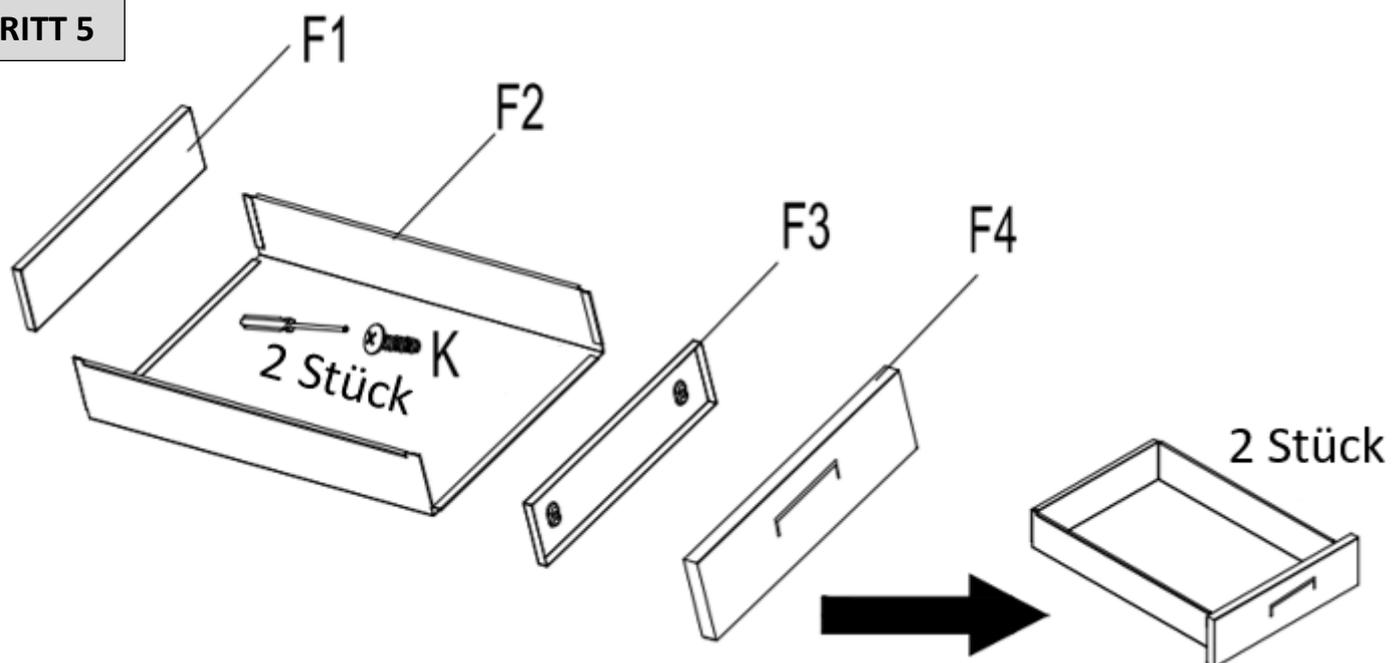
5. Montieren Sie die Teile F (1-4) wie abgebildet und verschrauben Sie die Schienen E an den Schubladenseiten
