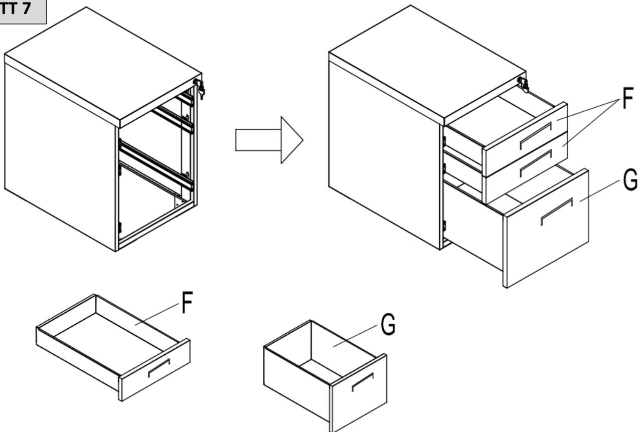
7. Schieben Sie die Schubladen F und G in den Korpus ein, indem Sie die beiden Teile der Schiene F miteinander verbinden
