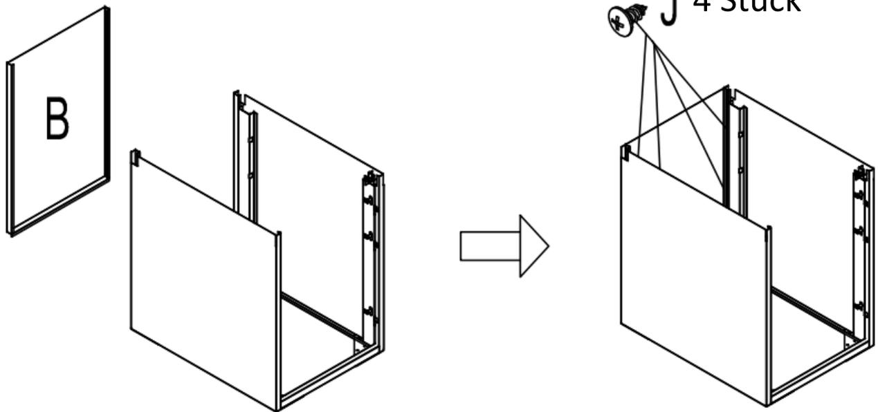
2. Montieren Sie das Teil B mit 4 Schrauben J
