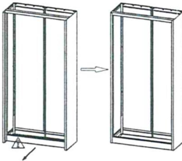
**SCHRITT 5** Montage der oberen Abdeckung (E) und der Bodenplatte (F)
