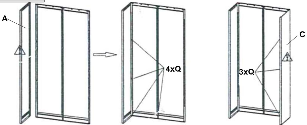
**SCHRITT 4** Montage des vorderen Rahmens (s. Schritt 1)
