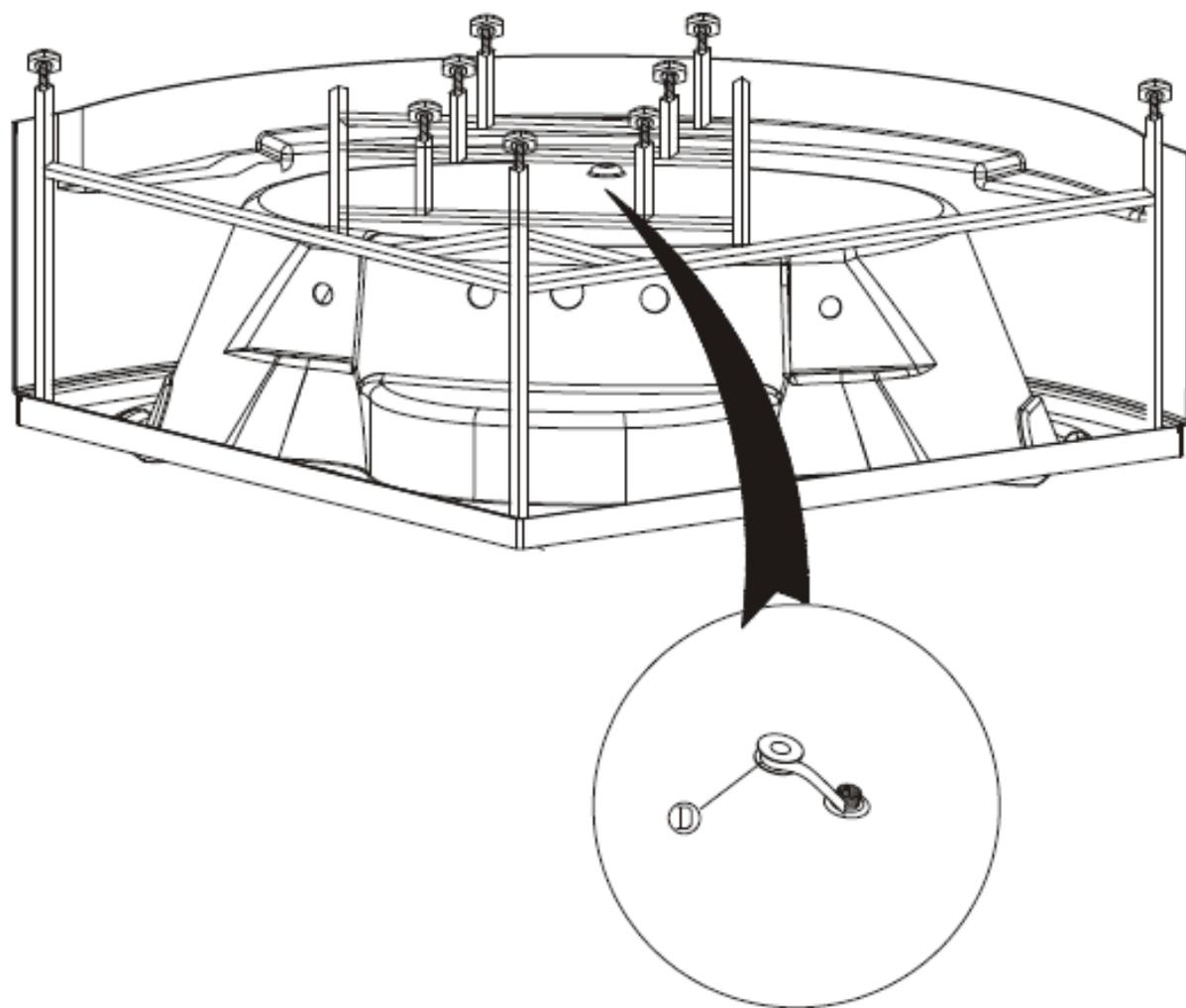
2. Montieren Sie, wie abgebildet die Wasserfall-Armatur und die Handbrause.
