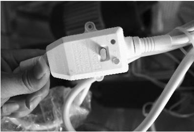
1. Wenn der Whirlpool in einem separatem Sicherungskasten abgesichert ist, entfernen Sie bitte den eingebauten FI-Schutzschalter.
