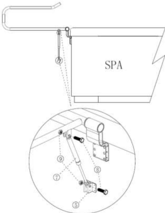
Installieren Sie die Gasdruckfedern (7) wie folgt:
