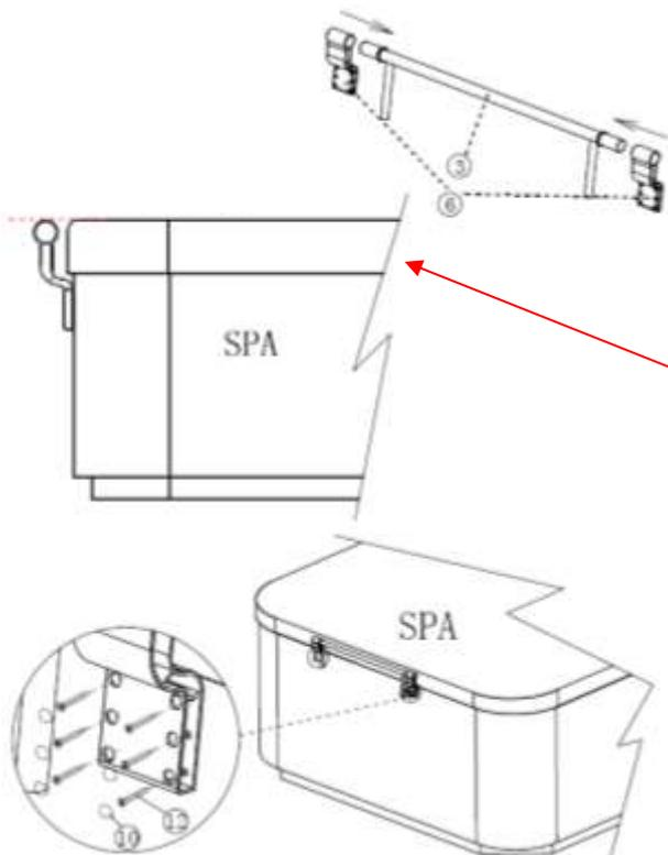
Platzieren Sie die Lifter-Tragegestange (3) mittels der Trägerplatten (6) mittig auf der gewählten Seite Ihres SPAs und fixieren Sie sie am Rand
