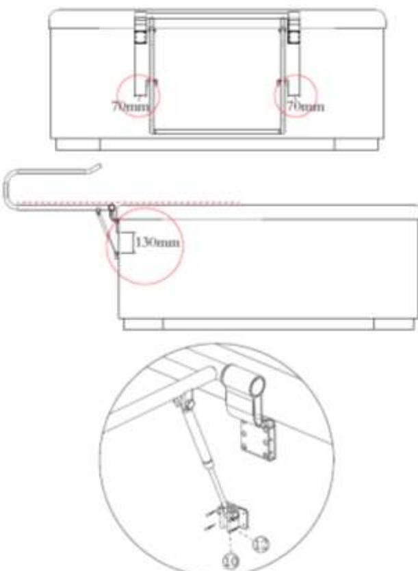
Im letzten Montage-Schritt fixieren Sie nun die Träger der Gasdruckfedern wie auf der Zeichnung dargestellt mittels der Schrauben (12) an der SPA-Außenseite.
